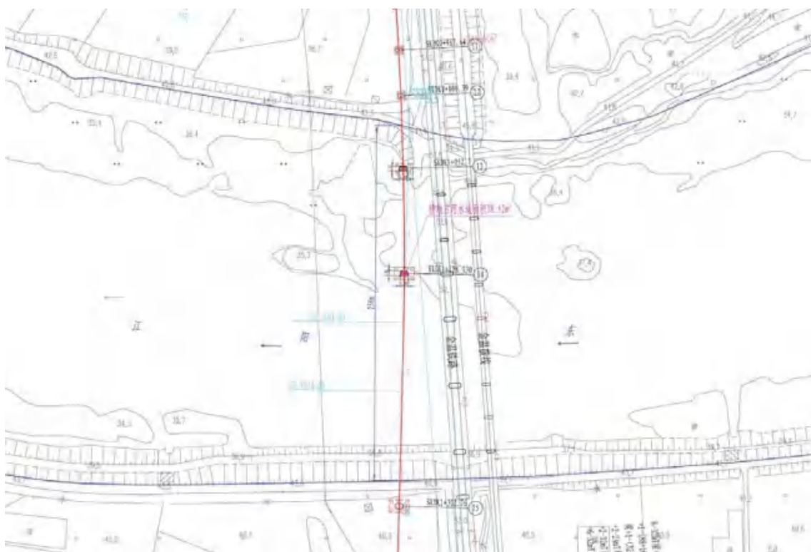
图 7.5-2 沪昆客车上行联络线特大桥跨东阳江平面布置图
